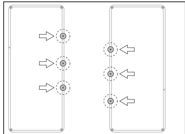
**8****IT** Fissaggio a pavimento della vasca
